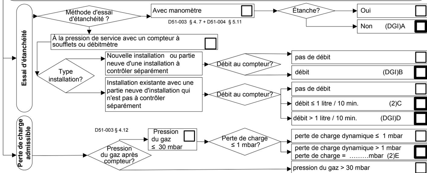
Si un **COMPTEUR A SOUFFLETS G4 ou G6** est **PRÉSENT**, fonctionnant à la pression de distribution (gaz naturel : 20/25 mbar), il sera utilisé comme instrument de mesure de l'étanchéité. Afin de s'assurer que le compteur n'est pas bloqué et qu'il peut indiquer un petit débit, il convient de créer un petit débit à l'aide d'un appareil d'utilisation.
