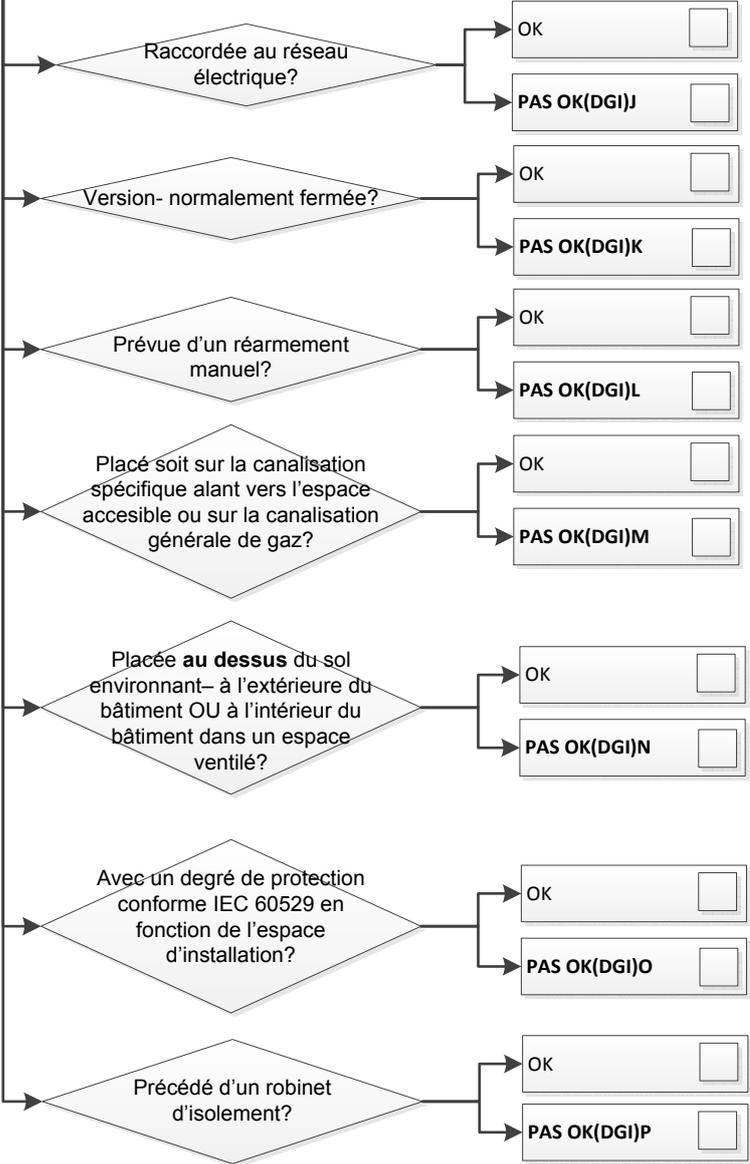
Installation conforme l' A.R.E.I., plus spécifiquement les articles traitant les espaces dans lesquels peuvent se créer des atmosphères explosives-- conformément à l'ATEX
